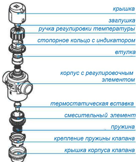
Рис. 2: Конструкция клапана ATM Kvs = 3,2 м³/ч и 4,2 м³/ч
