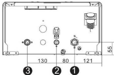
1. Обратка системы отопления  $\varnothing$  3/4 дюйма
