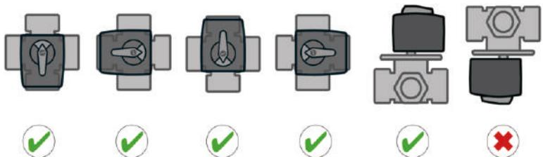
Клапаны с приводами **zeissler** могут быть установлены в любом положении кроме положения сервопривод снизу (как на рисунке). При проектировании и монтаже необходимо предусмотреть достаточно места для обеспечения доступа к приводу
