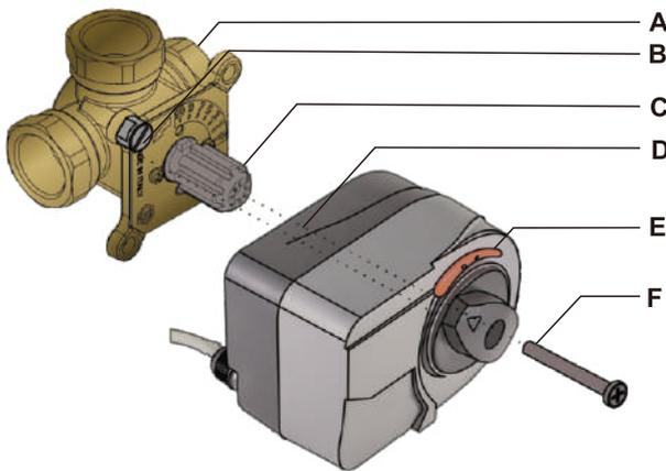
1. Поверните шпindelь клапана против часовой стрелки, чтобы он оказался в конечном положении (открытом или закрытом). Снять ручку поставляемую в комплекте с клапаном.
