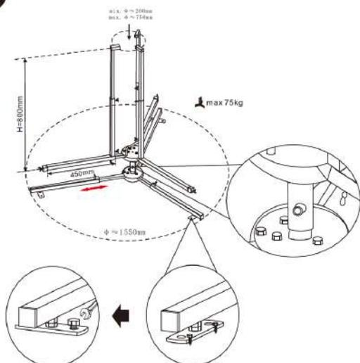
Для фиксации трубы, чтобы бухта не разваливалась, консоль раздвигается (рис. №3 и рис. №5), на нижнюю неподвижную опору устанавливается специальное зафиксированное кольцо направляющее трубу (рис. №4).
