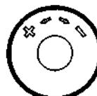
Терmostатический клапан устанавливается в прямом потоке прибора отопления (с протоком в направлении стрелки). Ось штока клапана ГЕРЦ для обеспечения оптимальной регулировки комнатной температуры должна находиться в горизонтальном положении.
