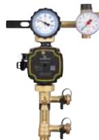
Комплект: циркуляционный насос Grundfos UPM 3 Solar 25-75; шаровой кран с гравитационным тормозом, термометром (синий) и соединением для группы безопасности; расходомер с устройством для наполнения и промывки; группа безопасности с предохранительным клапаном и манометром; изоляция; крепления для настенного монтажа.
