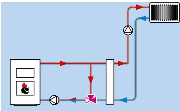
Термический клапан ATV может работать в отопительной системе без бака аккумулятора. В таком случае, необходимо использовать гидрострелку для разделения контуров. При этой схеме необходимо использовать два циркуляционных насоса.
