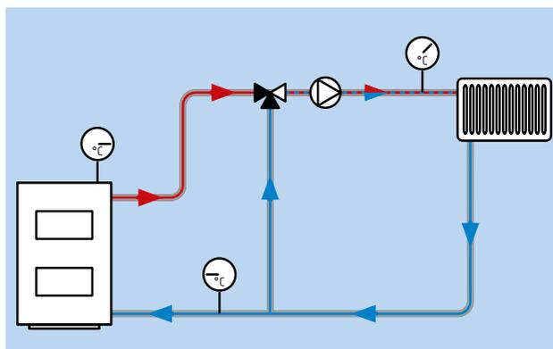
Термометры позволяют проверять температуру в системе горячего водоснабжения, в которой находится термостатический смешительный клапан (ATM AFRISO).
