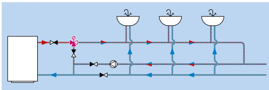
Клапан АТМ поддерживает постоянную (установленную) температуру в системе ГВС при наличии циркуляционного насоса. Обязательно использовать расширительный бак на подающей линии ГВС после клапана АТМ.
