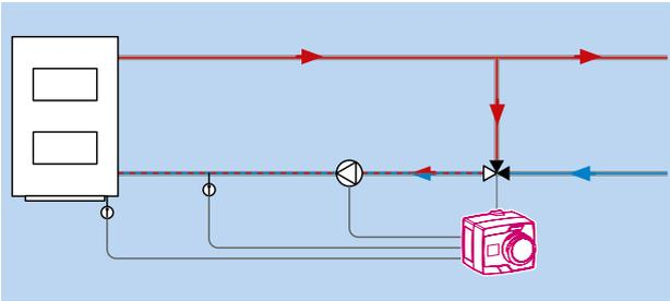
Управление 3-ходовым смесительным клапаном для поддержания установленной постоянной температуры теплоносителя на подающей линии, а также для защиты системы от перегрева или переохлаждения.
