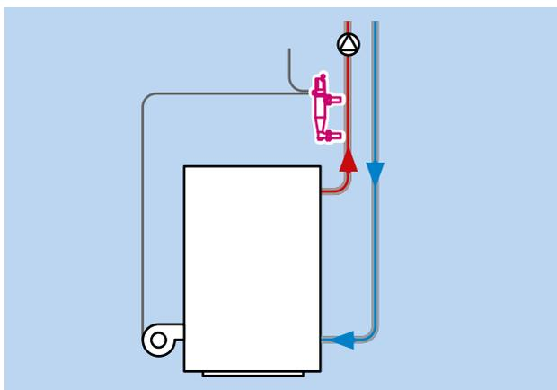
Датчик **WMS-WP6** необходимо устанавливать на подающей линии, выше котла и включить последовательно в систему электрического питания горелки (согласно электрической схеме в инструкции монтажа).
