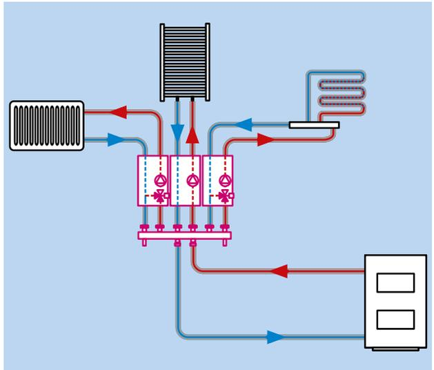
Схема использования двух насосных групп PrimoTherm: прямой и с подмесом, установленных на коллекторе KSV. Дополнительно насосная группа PrimoTherm 180-3 установлена для защиты котла от низкой температуры обратной линии.
