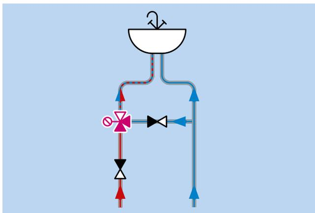
Клапан ATM поддерживает постоянную (установленную) температуру для выбранной точки водоразбора.
