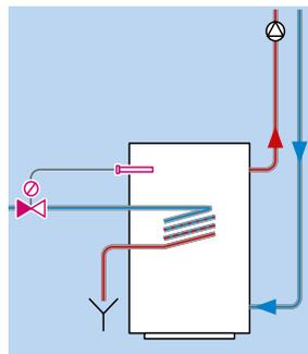
Аварийный клапан TAS от закипания котла предназначен для защиты твердотопливных котлов с мощностью до 100 кВт.
