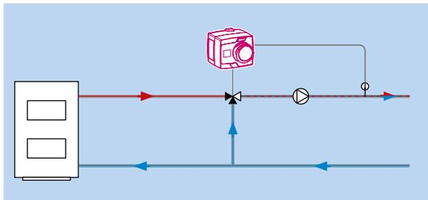
Управление 4-ходовым смесительным клапаном для поддержания постоянной температуры подающей линии и увеличения температуры обратного потока к котлу.
