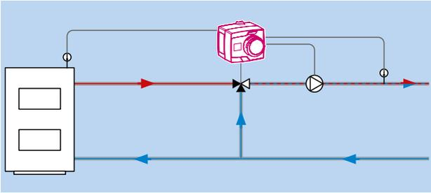
Управление 3-ходовым смесительным клапаном для поддержания установленной постоянной температуры теплоносителя на подающей линии и увеличения температуры обратной линии.
