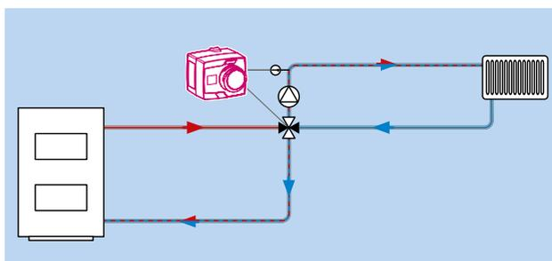
Управление 3-ходовым смесительным клапаном для поддержания установленной минимальной температуры обратного потока к котлу.
