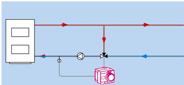
Управление 3-ходовым смесительным клапаном для поддержания установленной постоянной температуры теплоносителя на подающей линии, за теплообменником.
