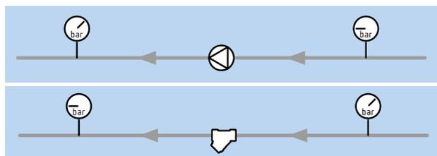
1. Измерение напора циркуляционного насоса (разница давления между всасывающим и напорным патрубками).
