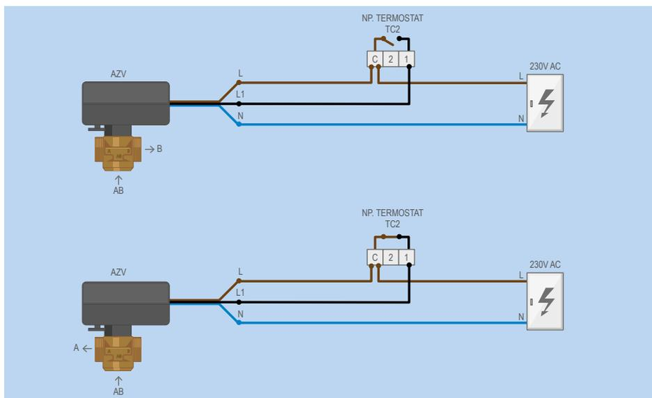
3-ходовой клапан AZV подключен к термостату водонагревателя или другому контроллеру.
