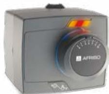
Приводами ARM 342 ProClick и ARM 349 ProClick возможно управлять 3-точечным или 2-точечным сигналом. Стандартно привода поставляются подготовленные для 3-точечного сигнала. Во время монтажа возможно переключить на сигнал 2-точечный.
