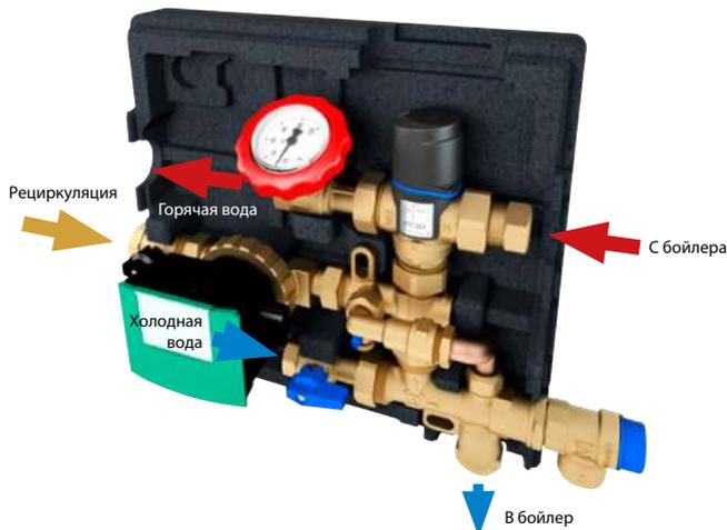
Компактная, испытанная на герметичность в горячем состоянии насосная группа циркуляции воды, состоящая из термостатического смесительного клапана с функцией защиты от ожогов, циркуляционного насоса, перепускно-развоздушного клапана, предохранительного клапана (давление открытия 6 бар, только версия WZS 100), отсечных клапанов и дополнительных компонентов.
