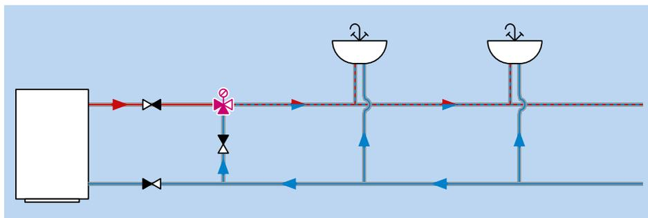
Клапан ATM поддерживает постоянную (установленную) температуру в системе ГВС.
