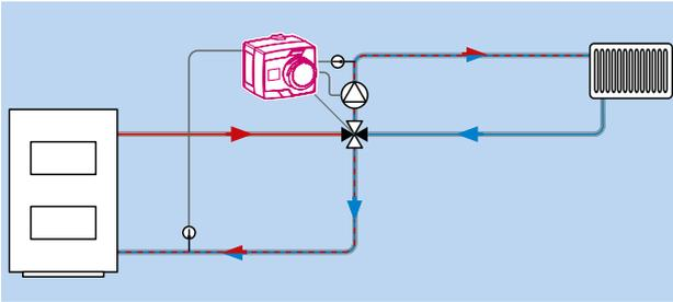
Управление 4-ходовым смесительным клапаном для поддержания установленной постоянной температуры теплоносителя на подающей линии и увеличения температуры обратной линии. Дополнительно привод-контроллер АСТ ProClick защищает систему от перегрева или переохлаждения.
