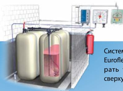
Система забора топлива Euroflex позволяет забирать топливо только сверху, не забирая шлам.
