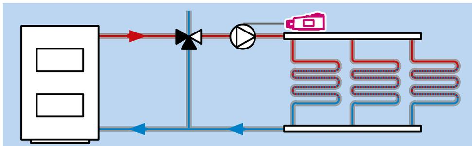
Накладные термостаты BRC необходимо использовать в системах из труб, восприимчивых к высокой температуре (например: системы теплого пола, отопительные системы из полимерных труб и т.п.). В случае аварии источника тепла и превышении максимальной рабочей температуры системы, термостат BRC отключает электрическое питание циркуляционного насоса.
