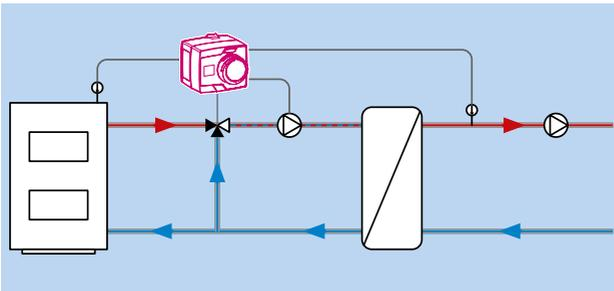
Управление 3-ходовым смесительным клапаном для поддержания установленной постоянной температуры теплоносителя за теплообменником, а также для защиты системы от перегрева или переохлаждения.
