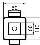
**Насосные группы PrimoTherm 180-1 и PrimoTherm-K 180-1** предназначены для прямой подачи теплоносителя от источника тепла в отопительную систему, без смешения. Рекомендуется использовать в качестве контура радиаторного отопления, контура вентиляции или контура загрузки бака ГВС. Группы PrimoTherm 180-1 снабжены запорными кранами, оборудованием для измерения температуры и обратным клапаном, защищающим от обратного потока.
