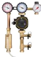
Комплект: циркуляционный насос Grundfos UPM 3 Solar 25-75; шаровые краны с гравитационным тормозом и термометрами (синий и красный), соединение для группы безопасности; расходомер с устройством для наполнения и промывки; группа безопасности с предохранительным клапаном и манометром; воздушный клапан в напорном трубопроводе; изоляция; крепление для настенного монтажа.
