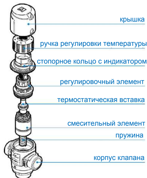
Рис. 2: Конструкция клапана ATM
