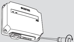
Модуль крепится на стену четырьмя винтами (крепеж в комплект не входит). Для установки снимите переднюю крышку корпуса
