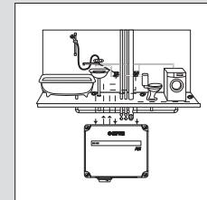
Отключите сигнал «Авария» снятием питания с модуля управления (клавиша внизу корпуса)
