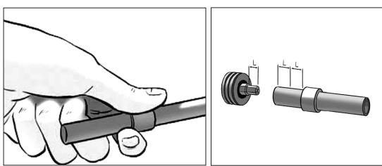
Наденьте пресс-гильзу на трубу фаской в сторону при соединения. Пресс-соединение должно монтироваться на прямом участке трубы (без изгибов) минимальной длиной, равной трём гильзам. При расширении трубы гильза должна находиться на расстоянии от края трубы, равном длине минимум двух гильз.
