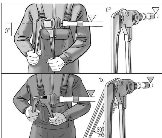
Подготовьте расширитель, накрутите на него насадку для расширения трубы, которая соответствует диаметру трубы.
