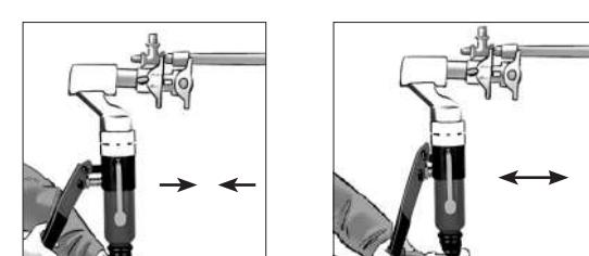
Установите насадки матрицы для обжима на рабочую ось пресс-аппарата и закрепите их крепежными штифтами. Поступательными движениями сводите и разводите рычаг (8) и рукоятку (5), чтобы надвинуть пресс-гильзу на фитинг.
