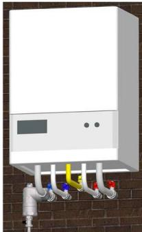
На рисунке изображен грязеуловитель установленный на горизонтальном участке трубы. Благодаря поворотному соединению, после установки, грязеуловитель принимает вертикальное положение. Такой способ подключения рекомендуется когда вы располагаете пространством по глубине большим чем по вертикали под котлом.
