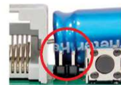
Джампер удален = энергосберегающий режим
