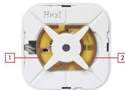
Замыкание контактов 1 и 2 для прописки датчиков
