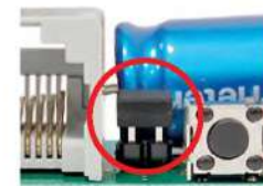
Джампер установлен = активный режим
