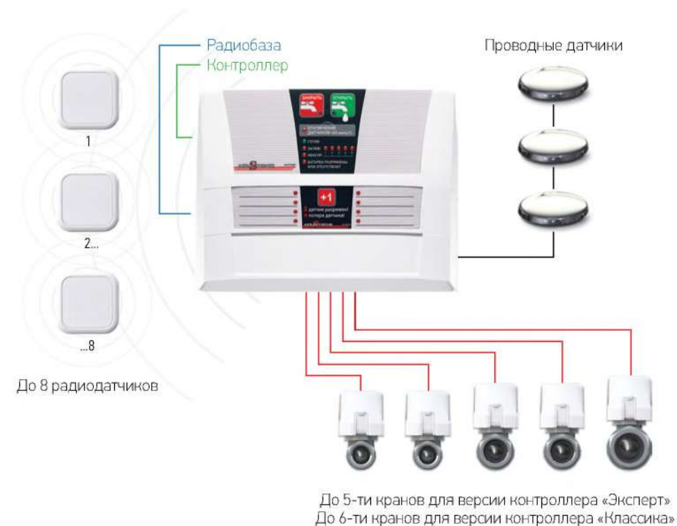
Схема работы системы «Аквасторож» с двумя типами датчиков – проводными и беспроводными
