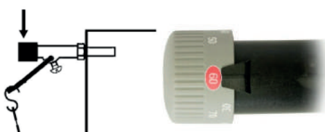
Рис. 3. Показания шкалы для горизонтальной ориентации регулятора
