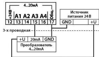
Рис. 18. Схемы подключения преобразователей в унифицированный сигнал 4...20 мА
