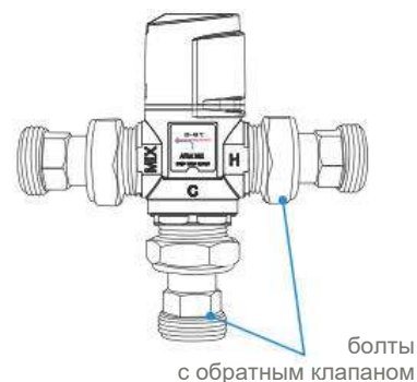
Рис. 2: способ установки болтов
