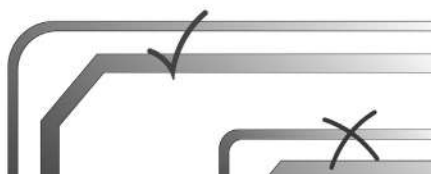
Рисунок 6 – Все изгибы должны иметь плавный переход
