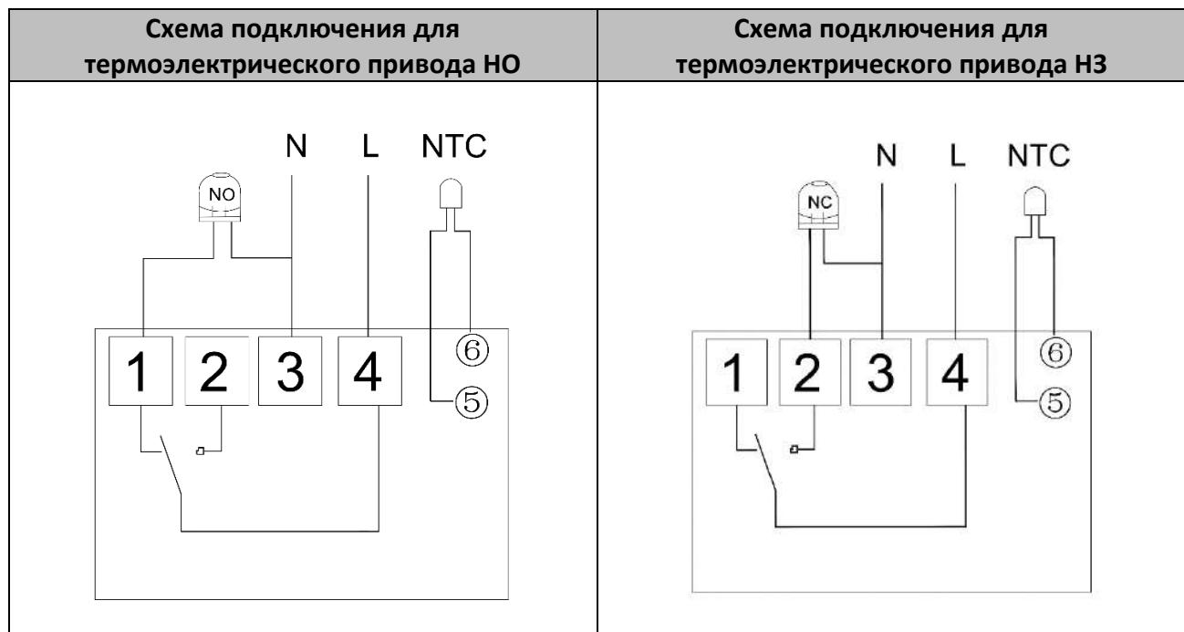
**Внимание!** Внешний NTC датчик является опцией, покупается и устанавливается отдельно, рекомендуемая длина кабеля 1.5–3 м. Рекомендуется устанавливать внешний предохранитель для защиты от перегрузки.
