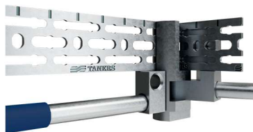
Применение шиногиба для создания многогранных форм шины
