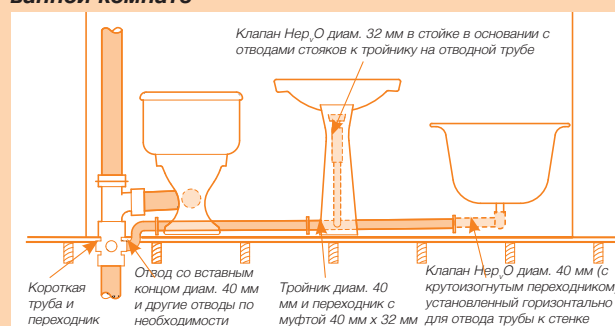
Рис. 10. Установка клапана Нер v О в типовой ванной комнате
