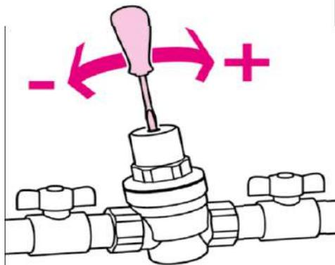
шлицевой отвертки. Вращение по часовой стрелке увеличивает значение настроечного давления. Вращение против часовой стрелки уменьшает давление.
