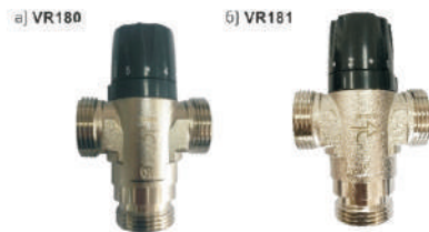
рис. 1. Смесительные термостатические клапаны VIEIR для отопления: а) - с диапазоном температуры 20 – 45 °С б) - с диапазоном температуры 35 – 60 °С
