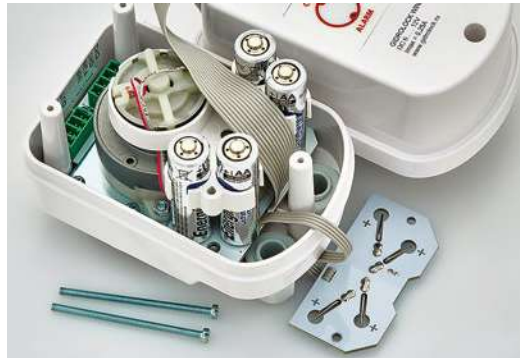
Фото 31. Контактная площадка снята, батарейки могут быть заменены
