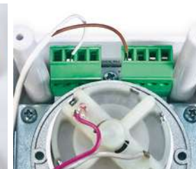
Фото 11. Подключение датчика к электроприводу
