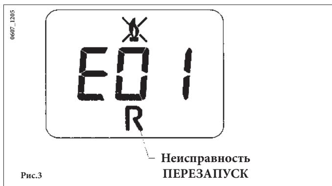
Для перезапуска котла ус тановите переключатель режимов (Рис.2) на 2 сек в положение «R». При повторных срабатываниях данного ус тво яния обратитесь в обслуживающую организацию.
