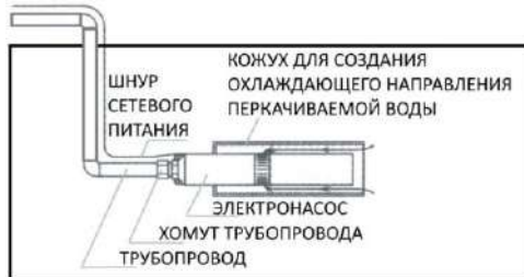
Рис. 5. Схема горизонтальной установки 3''БЦПЭ-0,5
