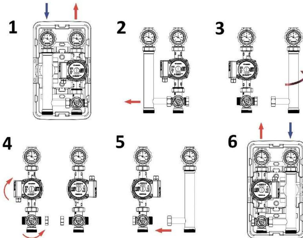
На заводе-изготовителе термостатический смесительный клапан с диапазоном температур от 25°C до 55°C настроен на температуру 35°C. Для регулирования температуры поверните регулятор по часовой стрелке для уменьшения и против часовой стрелки для увеличения температуры смешанного потока (см. «Таблицу регулировки температуры»). Цифры на регуляторе примерно соответствуют температуре смешанного теплоносителя с ориентиром на рельефный выступ на корпусе термостата «MIX».
