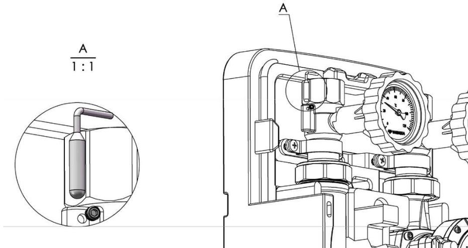
В шаровые краны с термометром, где есть паз под датчик, возможно установить термоэлемент выносного датчика, после установки датчика в паз необходимо его закрепить при помощи фиксирующего болта. Если необходимо установить сторонний датчик в паз шарового крана, то допускается размер штуцера датчика диаметром  $\varnothing 5$  мм.
